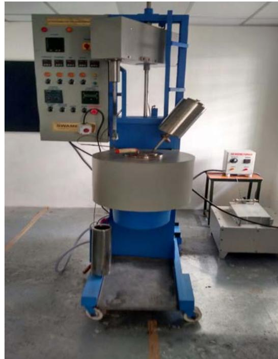
fig. 1 :stir casting setup
