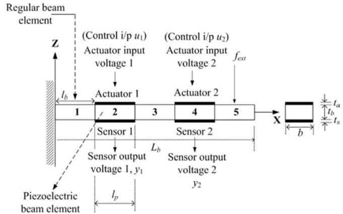
Fig. 2 : A MIMO smart beam (2 i/p & 2 o/p)
