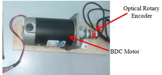
Fig. 3 Motor-Encoder Setup
