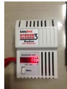
Fig. 1 Safety Siren PRO 3 radon counter
