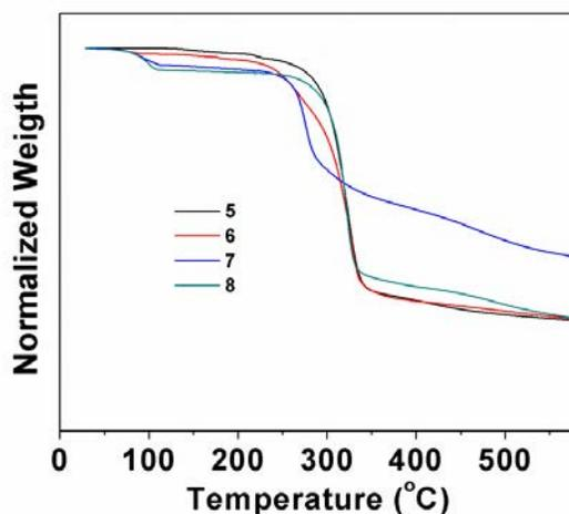
Fig. 6. TGA thermogram of Schiff bases 5-8.
